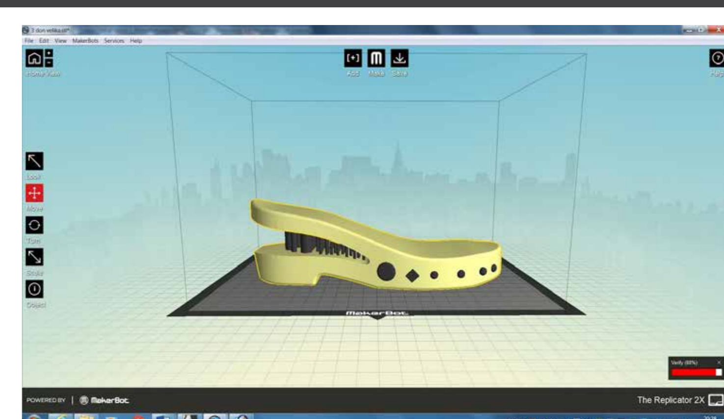
sl.6., prikaz pozicioniranja modela na radnoj podlozi i definiranje parametara za tisk
